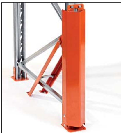
Stolpförstärkning 90/110 hög - för montage tillsammans med stofsotplatta. Ger absolut bästa skydd av den mest utsatta delen av stolpen. Höjd 760 mm.
