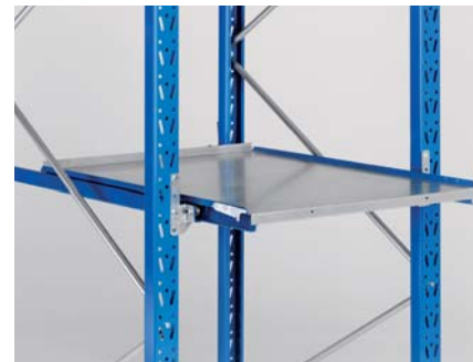
Utdragsplan – för plockgods utan pall. Ger bästa ergonomi vid plockning. Montage i gavlar. Max belastning 300 kg.
