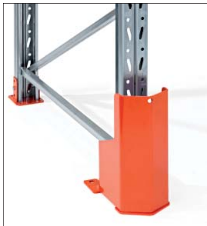
Pylväänsuoja 400 mm PU-jousella - asennetaan betonilattiaan. Parantaa suojan törmäyskestävyyttä.
