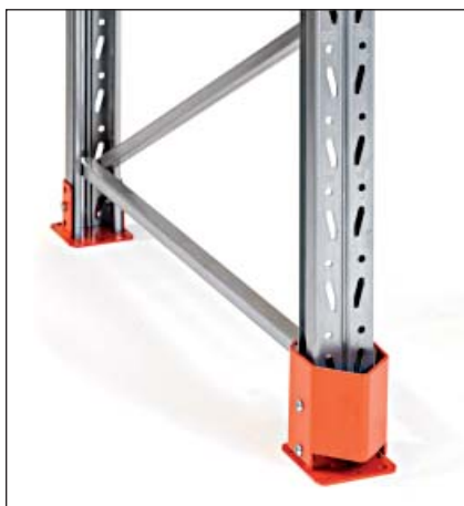
Pylväänvahvike 90 - yhdessä suojia-aluslevyn kanssa. Estää pylvään vaurioitumista ja vie vähän tilaa. Korkeus 150 mm.
